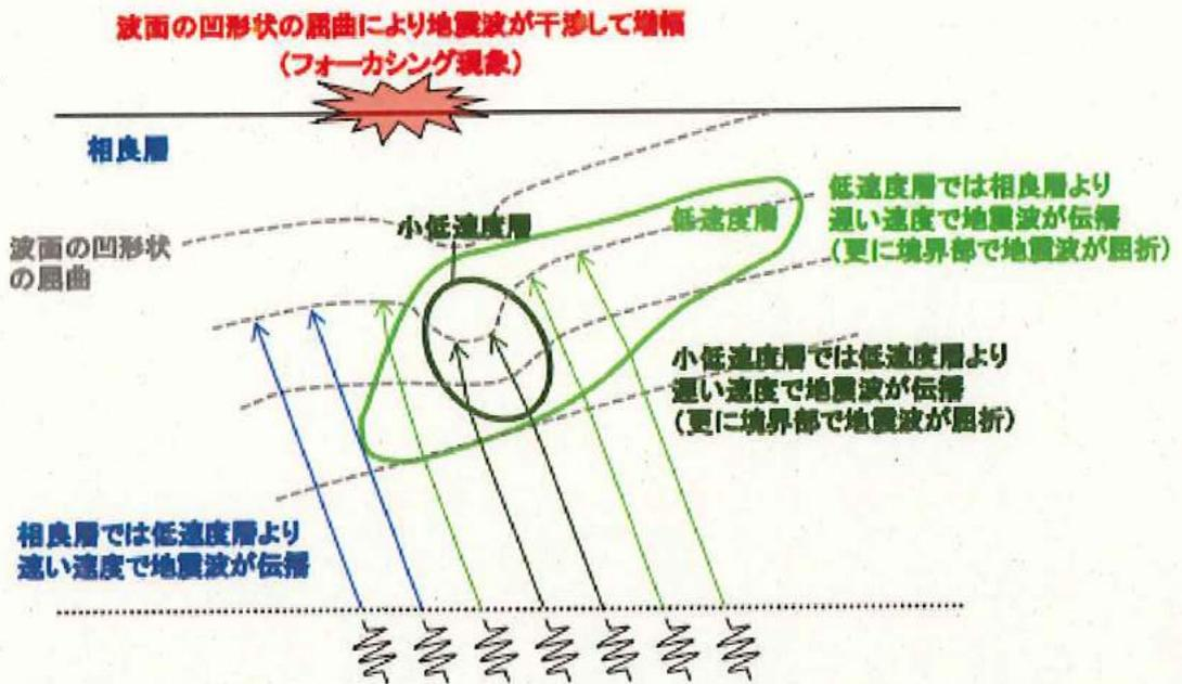
図95 浜岡原子力発電所5号機の地震動の増幅メカニズム
