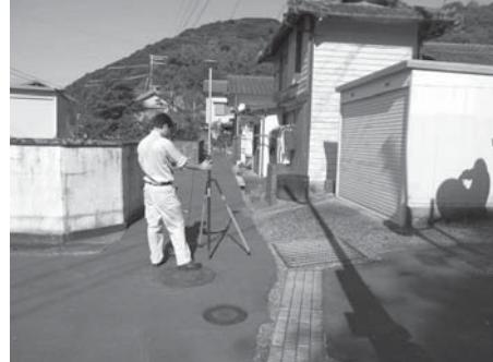
写真 18 沖松浦の GPS 標高測定
