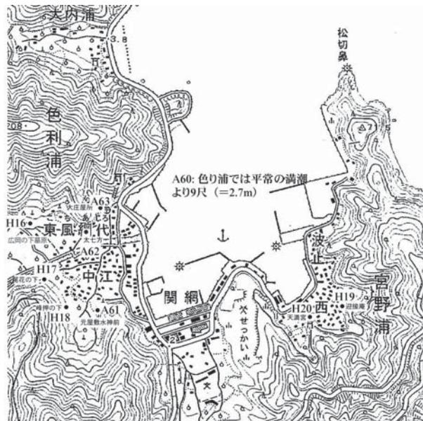
図 65 色利浦の宝永地震津波の高さ (H16 ~ 20)、および安政南海地震津波の高さ (A60 ~ 63) の判明点 (千田ら、2004 による)。
